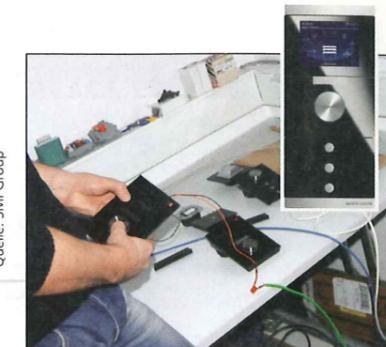
Bild 4: Eine dynamische LED-Farbsteuerung lässt sich per KNX-Protokoll realisieren – bedient über einen »Busch priOn«; hier ein Blick auf den Test des Systems
